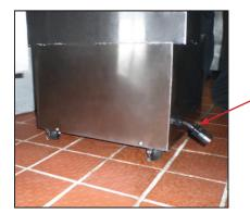
HEATER CORD PLUG – CONNECT THE MOLDED POWER CORD (SUPPLIED) INTO THE HEATER PLUG TO HEAT GREASE.
