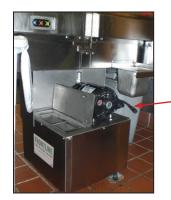
**MOTOR CORD PLUG** – CONNECT THE MOLDED POWER CORD (SUPPLIED) INTO THE MOTOR PLUG TO PUMP THE GREASE.
